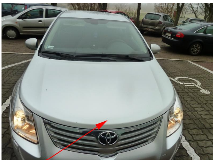
Punktowy odprysk lakieru.
